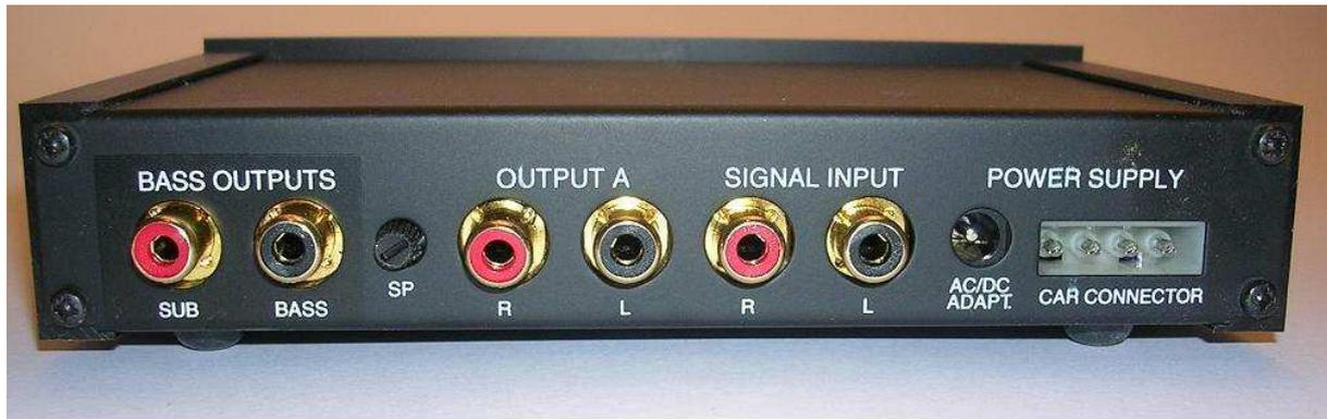
**Fig. 5 La face arrière du DBS 12**
